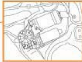
Fensterhebermotor mit integriertem Türsteuergerät
